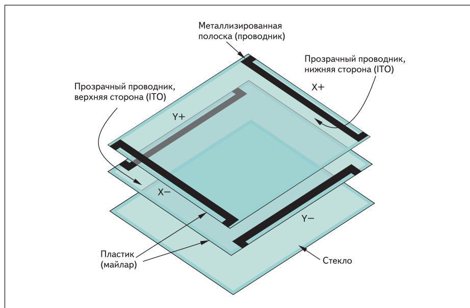
Рис. 1. Устройство 4-проводной резистивной сенсорной панели
